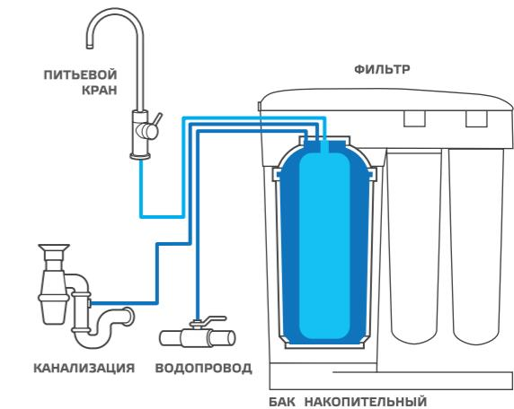
В водо-водянном баке весь объем занят чистой водой, что позволяет уменьшить его габариты; противодавление не создается, следовательно, скорость фильтрации остается неизменно высокой, а количество сбрасываемой в дренаж воды — минимальным.
