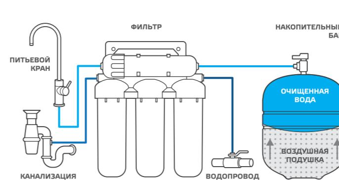
Накопительный водо-воздушный бак имеет две полости: одна предназначена для очищенной воды, другая — для воздуха. При наполнении бака чистой водой воздух сжимается и если открыть кран, воду выталкивает. Растущее на воздух давление приводит к падению эффективности системы: скорость фильтрации серьезно снижается, количество сбрасываемой в дренаж воды растет.
